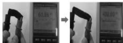
Figure 36. 알파클로의 스트레인 센서 (인장 변형에 따른 전기저항의 증가).
