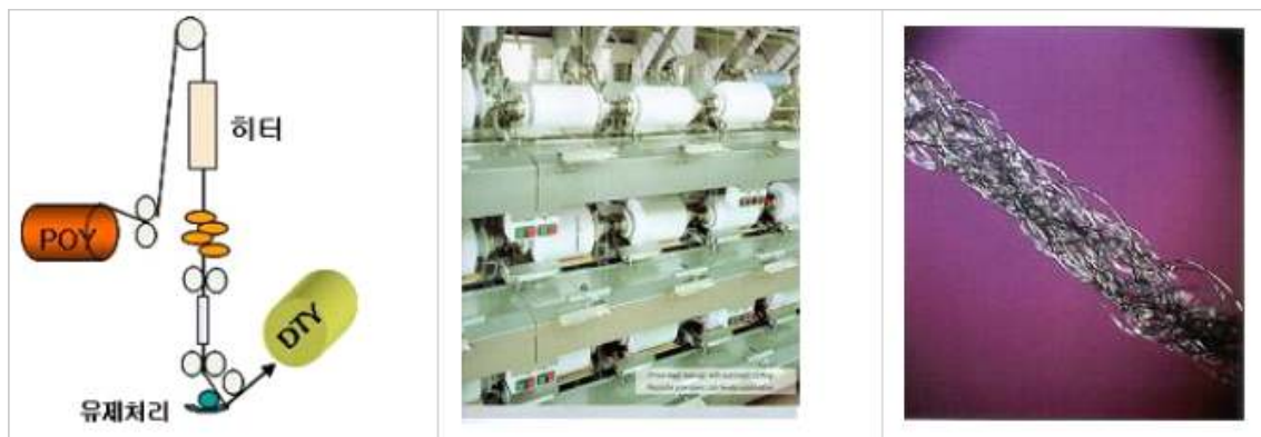
그림 2. 연신 공정 (모식도-연신기계-연신사)
