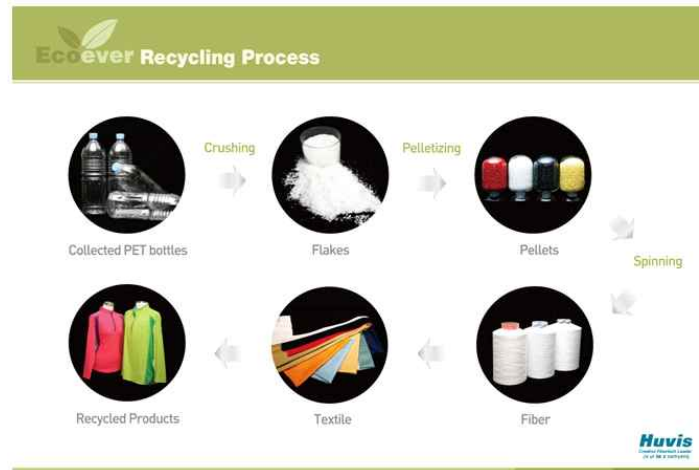
그림 16 Ecoever의 리사이클 공정
