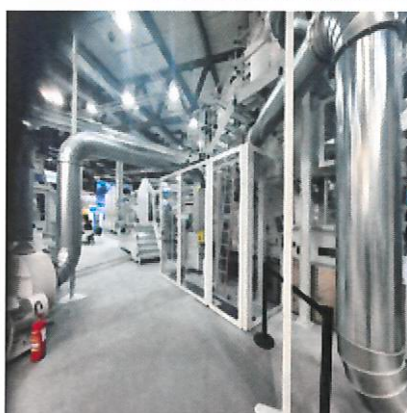
[ 폐자원을 이용한 스펀지 타입의 시트 제조 장비 및 제품]
