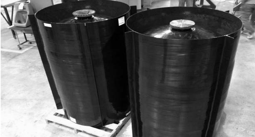
<극저온용 복합재료로 만들어진 액화산소저장용기>
