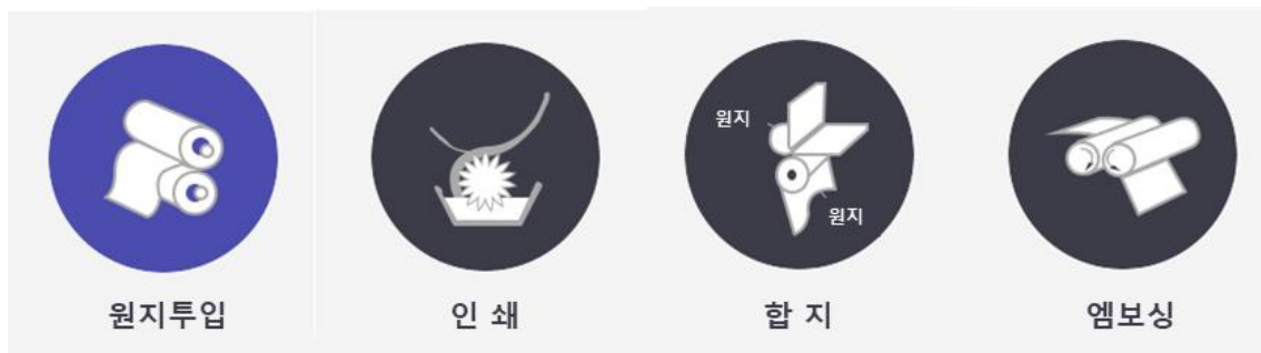
Figure 7. 종이 인테리어 벽지의 생산공정도.
