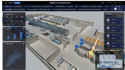
그림 15. W社의 디지털 트윈기반 시화공단 에너지효율화 모니터링 시스템
